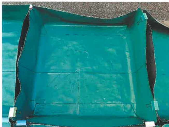
2 号试验箱 T 型缝及阴角图片
