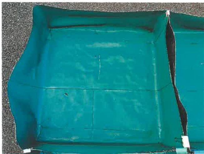
1 号试验箱 T 型缝及阴角图片
