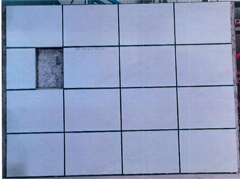
耐候性试验墙板照片 (试验前)
